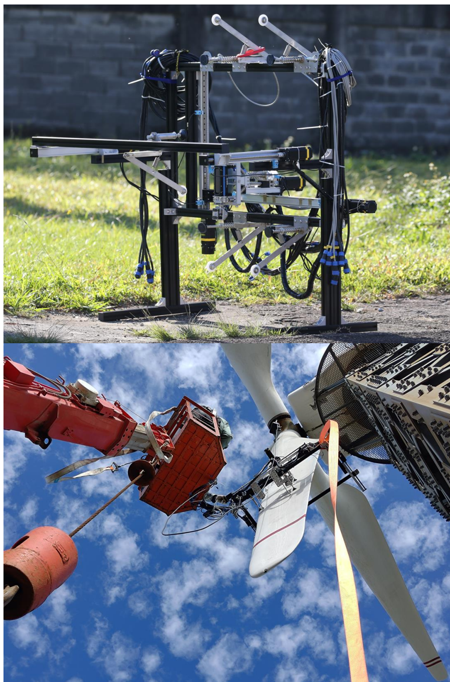
圖 16、高空型葉片檢測系統應用於本院 150kW 風機葉片檢測
