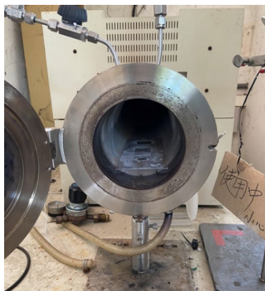
圖 1.1.12 試片預長氧化層的高溫爐管裝置。
