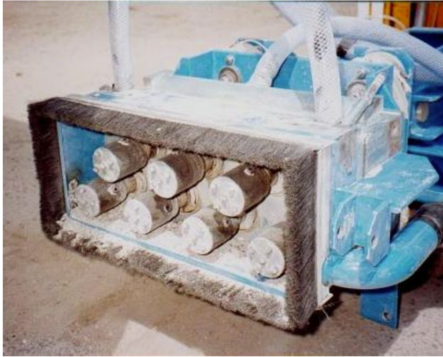
圖 1.2.9 7 頭牆壁粗琢器範例[9]
