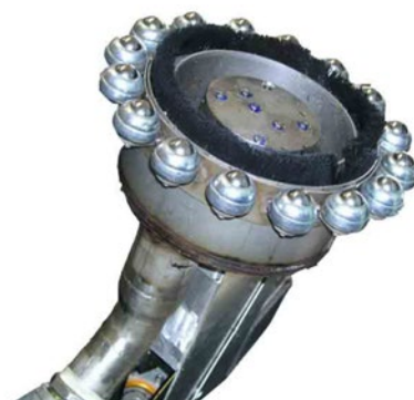
圖 1.2.41 利用遠程 hydrolasing 去除凝土表面[12] 圖 1.2.42 安裝在真空罩內的水磨噴嘴[12]
