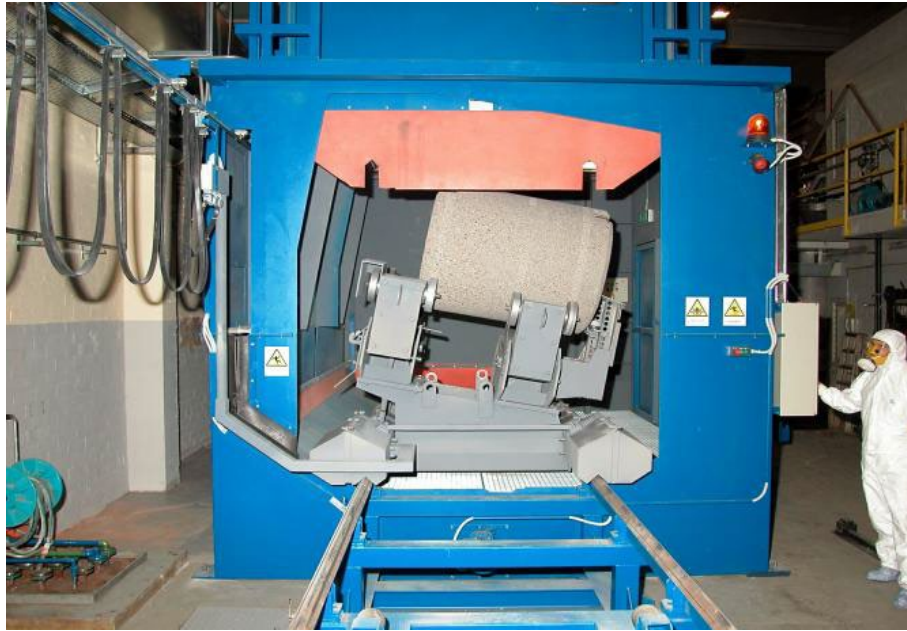
圖 1.2.27 用於混凝土容器除污的噴砂裝置[9]
