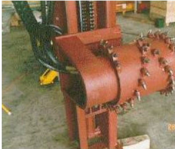
圖 1.2.22 TT1 計畫所使用的研磨頭[9]
