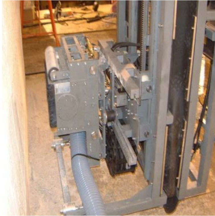
圖 1.2.20 線性驅動器上的鑽石研磨頭[9]
