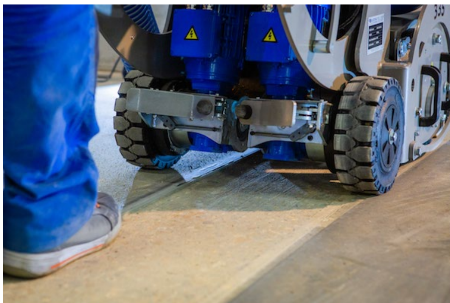
圖 1.2.48 混凝土刨除機(2) [18]
