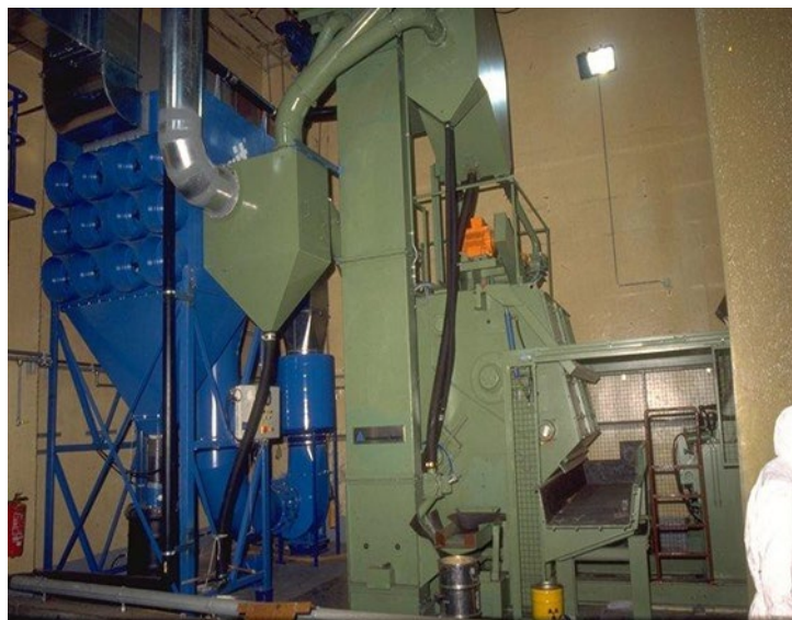
圖 1.2.29 小型混凝土塊的乾式噴砂裝置[9]
