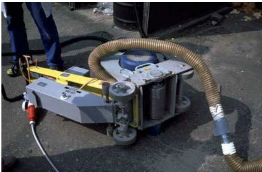
圖 1.2.23 鑲有鑽石地板刨除器[9]
