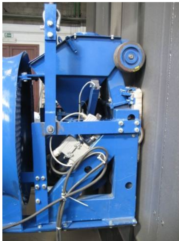
圖 1.2.26 內建旋風分離器的垂直噴砂設備[9]
