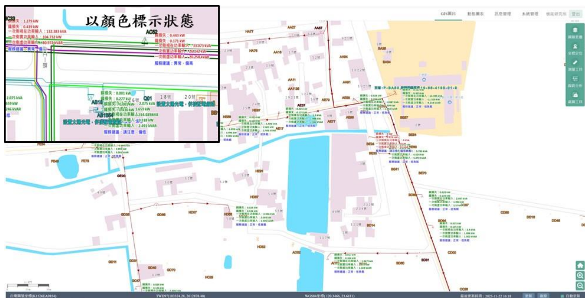
圖 9 變壓器狀態標示於動態地理空間資訊整合平台
