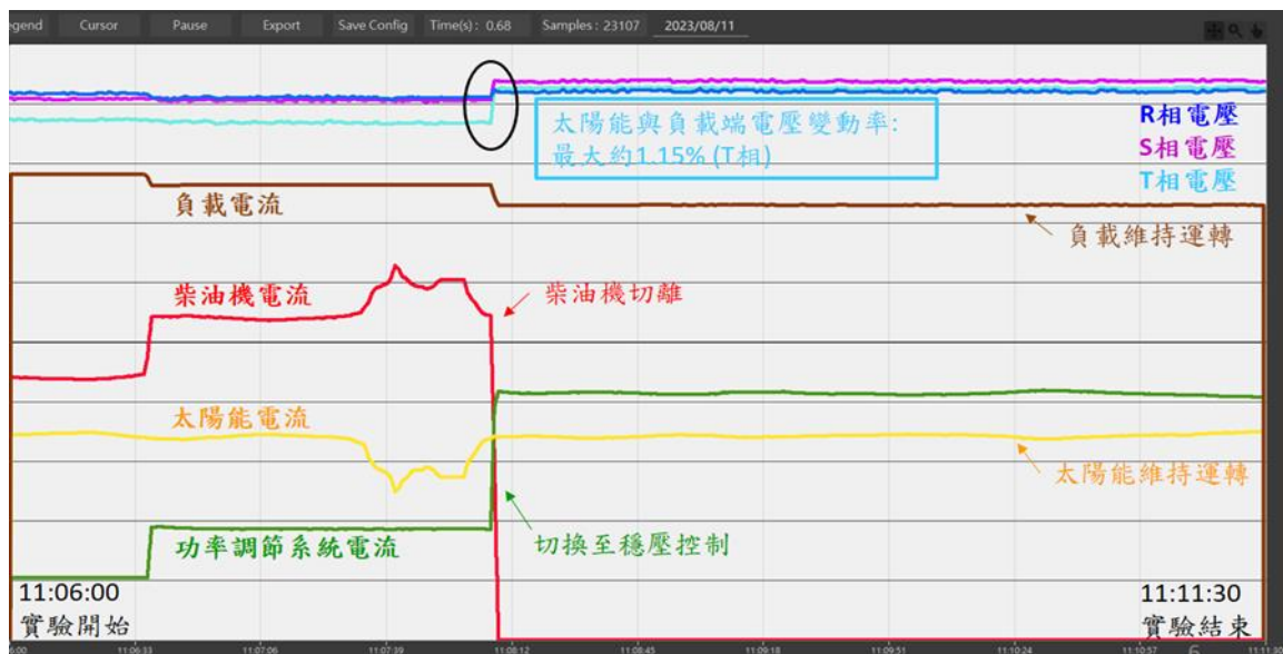
圖 22 關閉柴油機後，功率調節系統切換至電壓控制之實測
