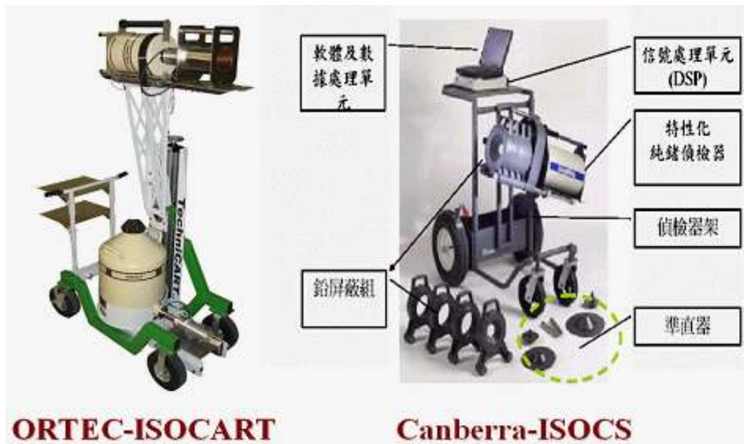
圖 1-1.7：移動式低放射性廢棄物加馬活度量測系統
