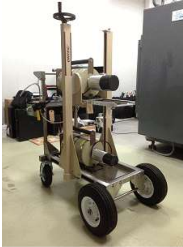
圖 1-1.5：低能量純鎘加馬核種量測系統(ISOCART)
