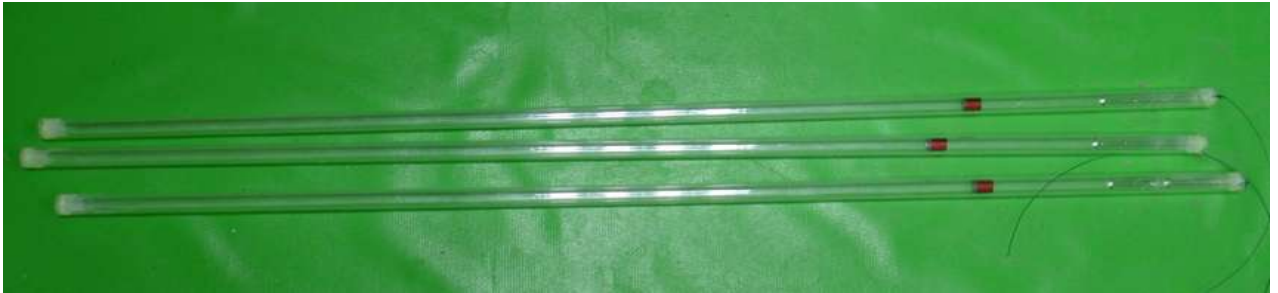
圖 1-1.3： ^{241}\text{Am} 液態棒狀射源
