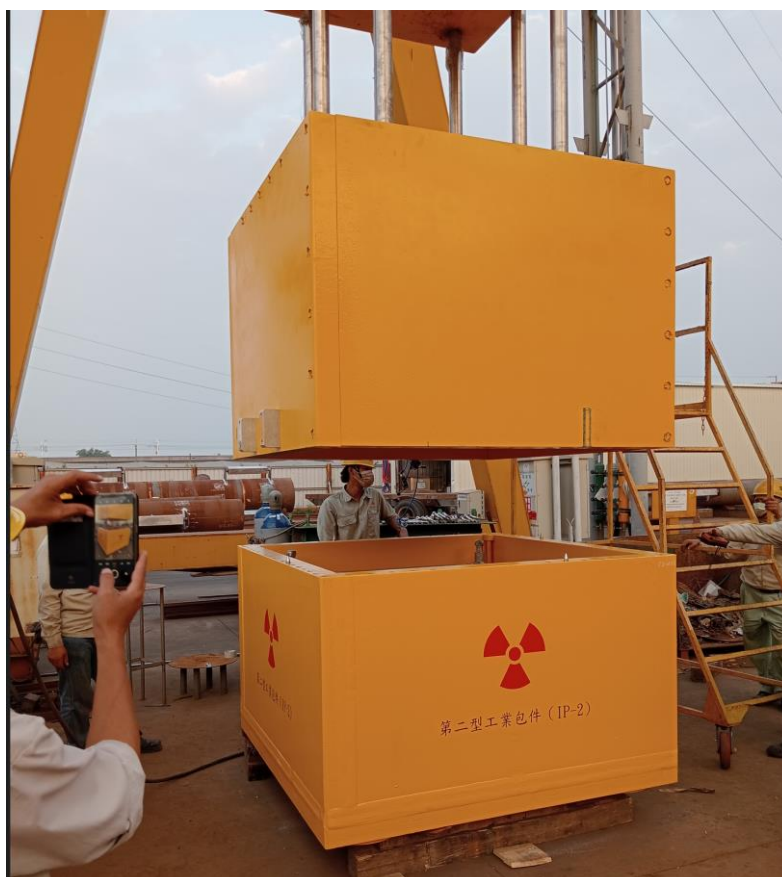
圖 2-19、提籃執行傳送測試(○○鋼鐵公司)
