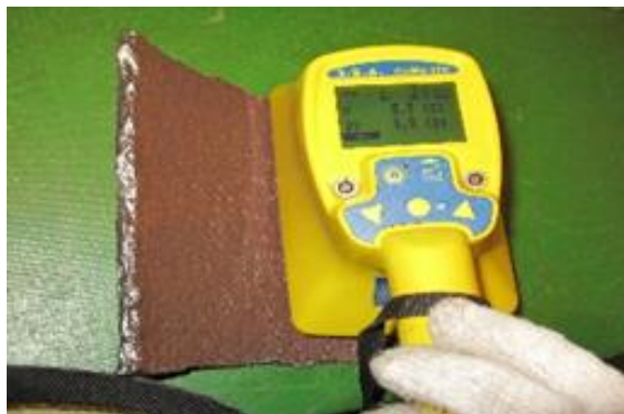
圖 2-12、完成 10 公噸金屬廢棄物偵檢、篩選及機械除污處理
