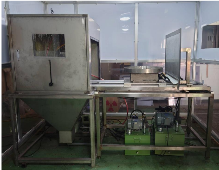
圖 2-31、完成高壓水除污噴洗設備建置與實測
