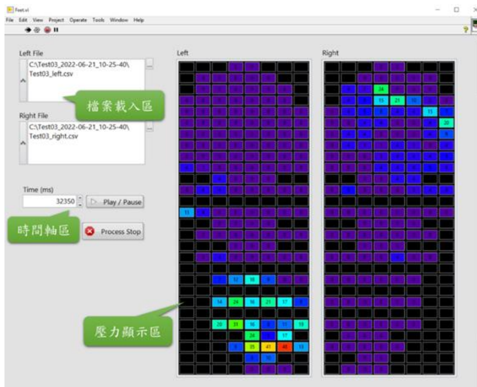
圖 4-21、足底施力分析程式。使用 LabVIEW 開發足底壓力分析程式同步左右腳資料，並將大量數字資料以動態圖形化介面呈現，可精確觀察特定時間左右腳壓力分佈的變化
