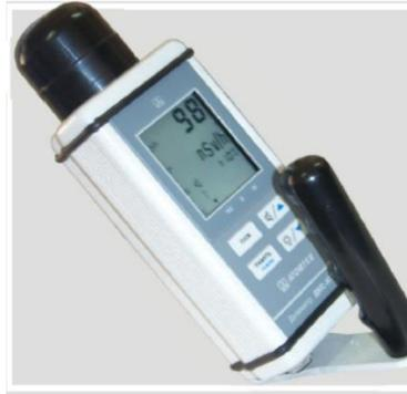
圖 2、手提式加馬直接輻射偵檢儀器
