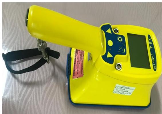
圖 3、手提式表面污染偵檢器
