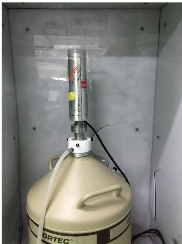
圖 4、加馬能譜計測系統。
