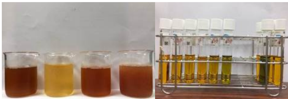
圖 21：離心後的液體進行 COD 檢測
