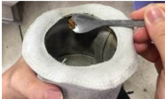
圖 11：將濾布的固體取出
