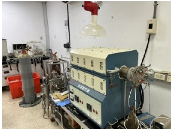
圖 19：將坩鍋放入高溫爐 575°C、3 小時
