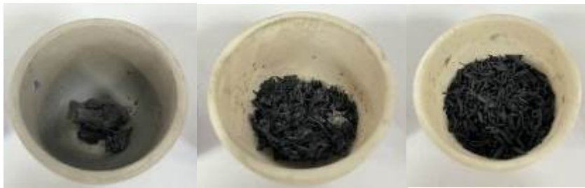
圖 20：進入高溫爐後的渣料
