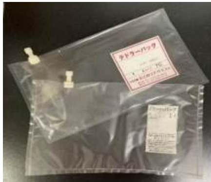
圖 24：集氣體所使用之氣體採集袋
