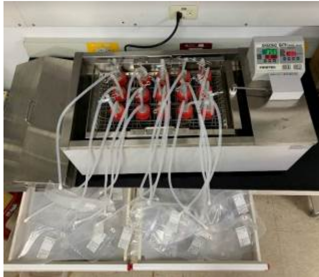
圖22：厭氧消化試驗之完整裝置圖
