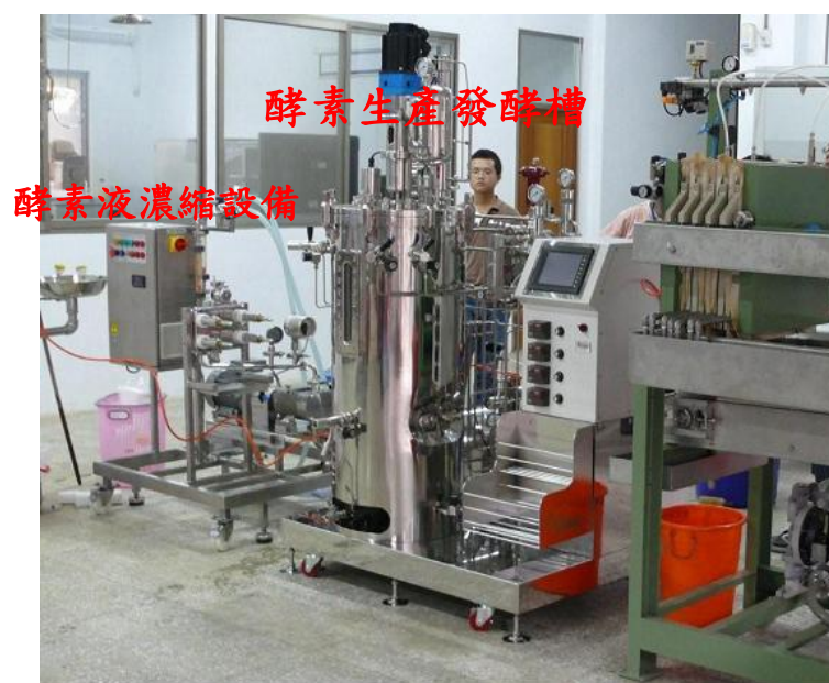
圖 2-2 100L 酵素生產發酵槽及其酵素粗萃液濃縮設備
