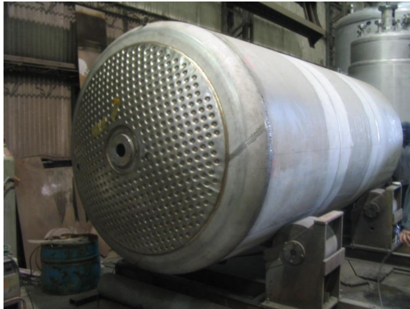
圖 1-1 施工製造中之發酵桶槽
