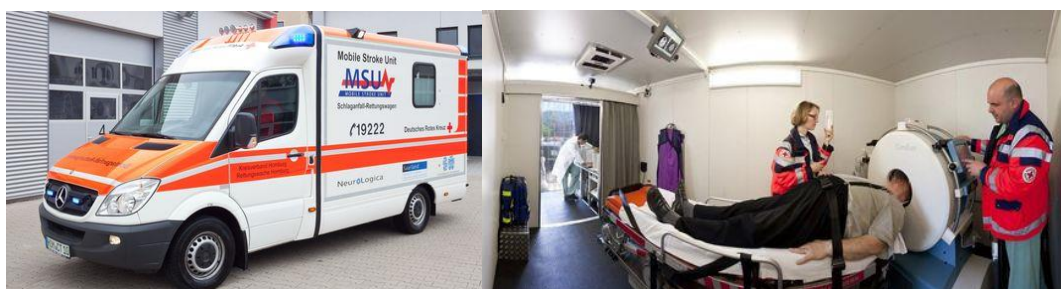
圖 32、車載型 CT 在移動中風科的救護車之示意圖 3
