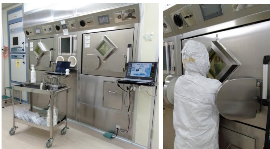
圖3.23. 實際熱鉛室示意圖(左)和藥物分裝實際作業情境(右)
