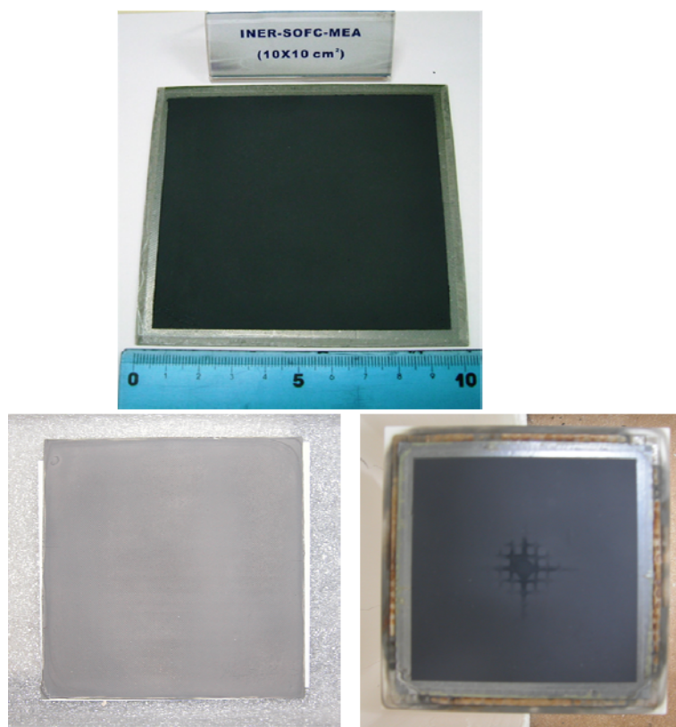
圖 4-3 耐久性測試前後之 MEA 外觀相片
