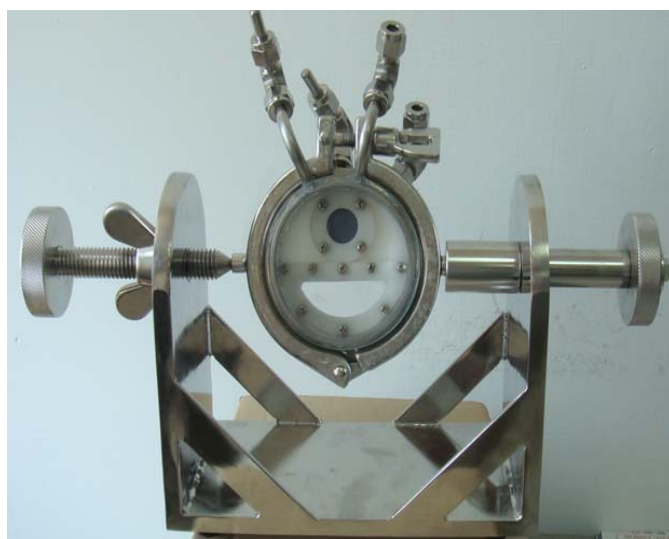
圖 3-3 氫氧分離產氫反應系統-產氫系統之有效氫氣及氧氣分離、收集系統，以離子交換膜及雙面電極所組成之氫氧分離產氫反應器實驗室級原型設計
