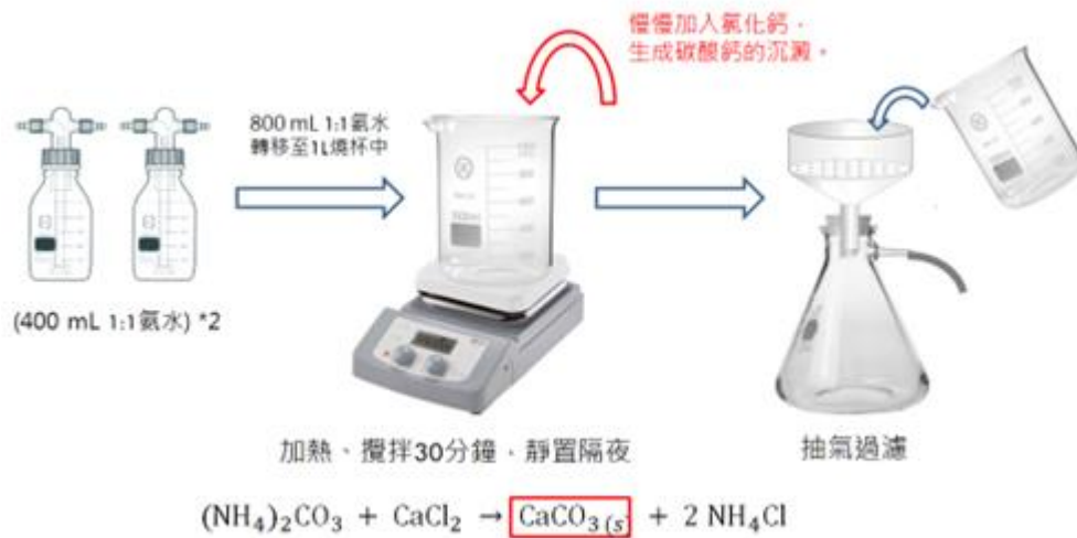
圖 7 以布氏漏斗過濾後濾紙進行乾燥至恆重
