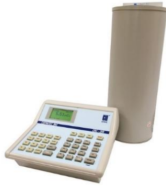
圖 3、透過井型游離腔實測射源活度。
