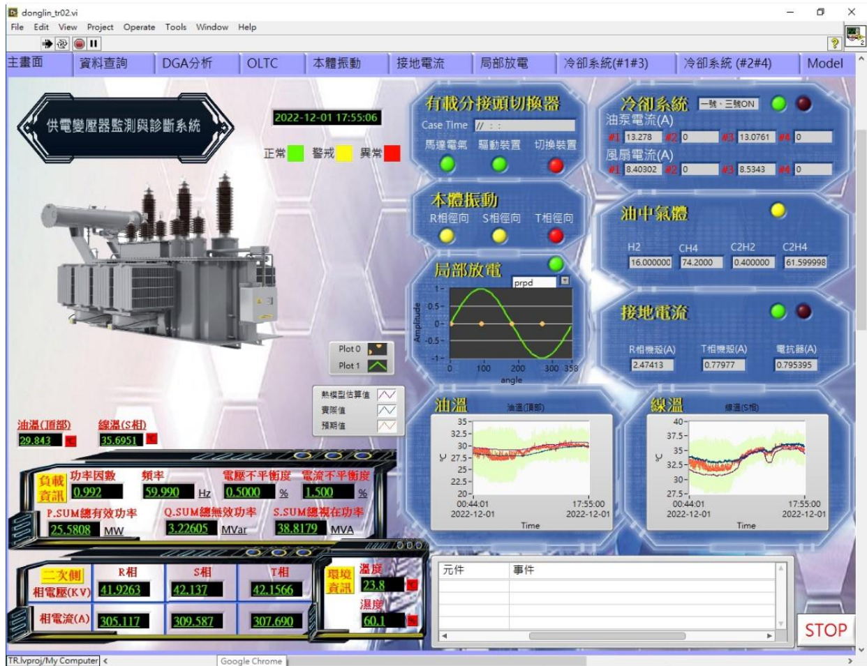
圖 24 包含各項基線模型之供電變壓器運轉效能評估與智慧診斷平台
