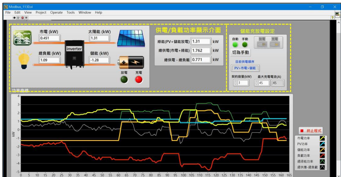
圖 21 充電站自動調度監控系統(LabVIEW 版)
