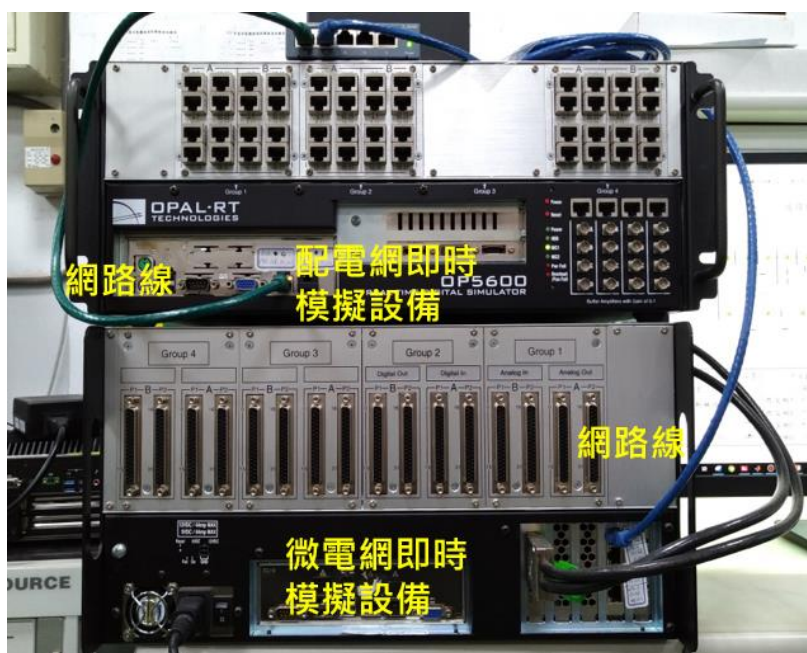
圖 8 共模調度管理平台之硬體設備架構
