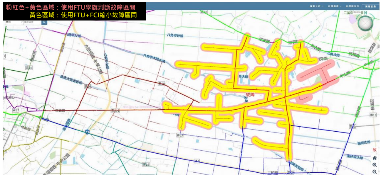
圖 5 故障指示器於地理資訊系統標註以縮小故障區間(縮為黃色)
