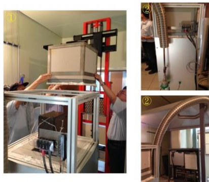
圖9. 進行高溫爐放置作業及安裝連接系統與抽風櫃之排氣管線
