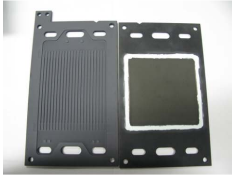
圖 27. 電漿噴塗 LSM 保護膜披覆於陽極端板與電池框架之實體照片
