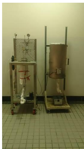
圖 16: 觸媒床放大後 \text{NH}_3 觸媒氧化反應裝置圖
