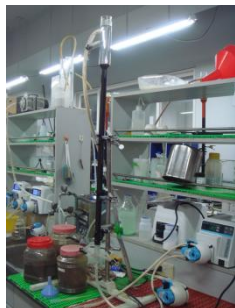
圖 2-2 純化 BT9 流體化床反應器示意圖
