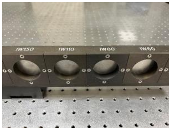
圖 26：INER 035 館組配之寬能譜系列射質附加過濾片
