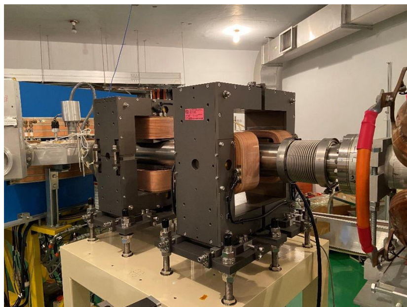
圖 4-1、加速器中子源射束線組件掃描磁鐵組
