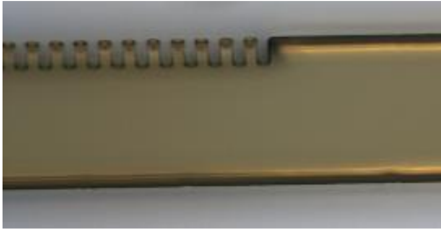
圖 4-44、布拉格光纖光柵實體結構圖
