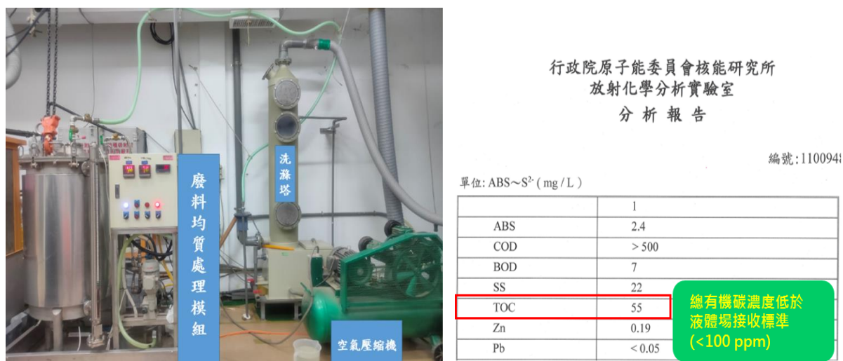
圖 2-17、放射性有機廢液總有機碳(TOC)降解實體設備
