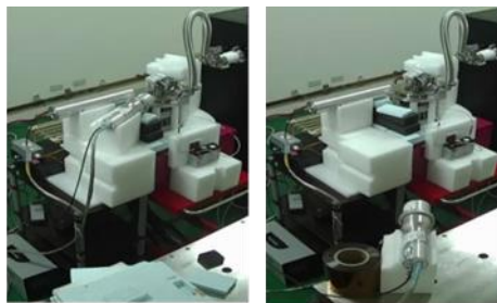
兩台閃爍體PMT偵檢器在不同距離的量測
