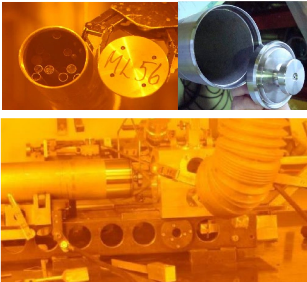
圖 2、瑞典受損燃料裝罐作業流程照片
