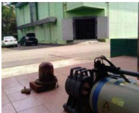
ISOCS 儀器廢射源進行核種活度分析
