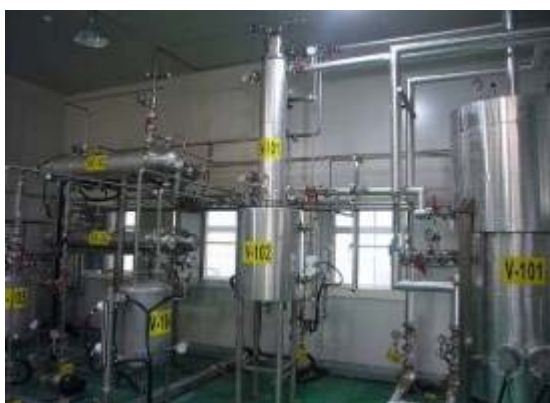
圖示實驗型高導電度廢液蒸發處理設備
