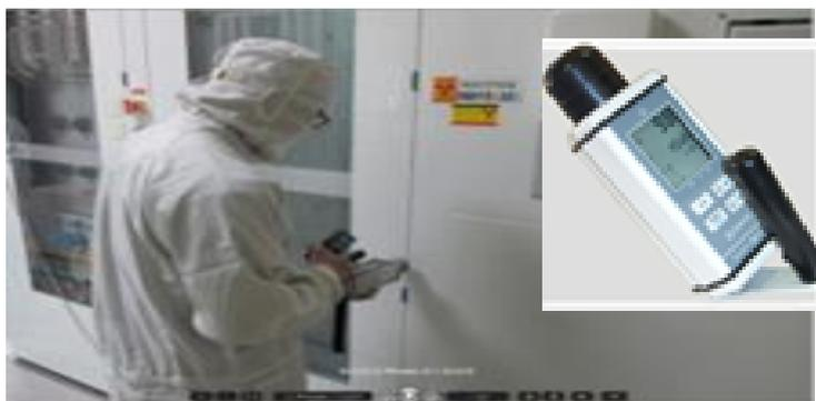
圖 1. 手持式塑膠閃爍偵檢器 ATOMTEX AT1121
