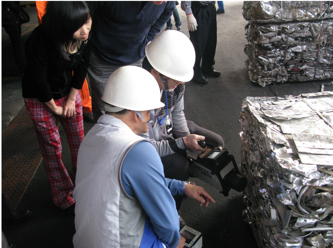
圖 11. 大港倡議計畫輻射異常物貨櫃現場偵測紀實(電冷式純者偵檢器)
