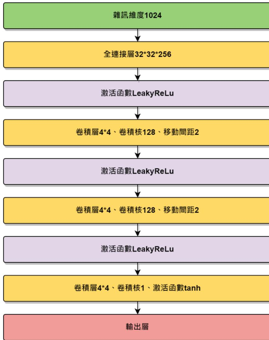
圖 26 DCGAN 生成模型架構
