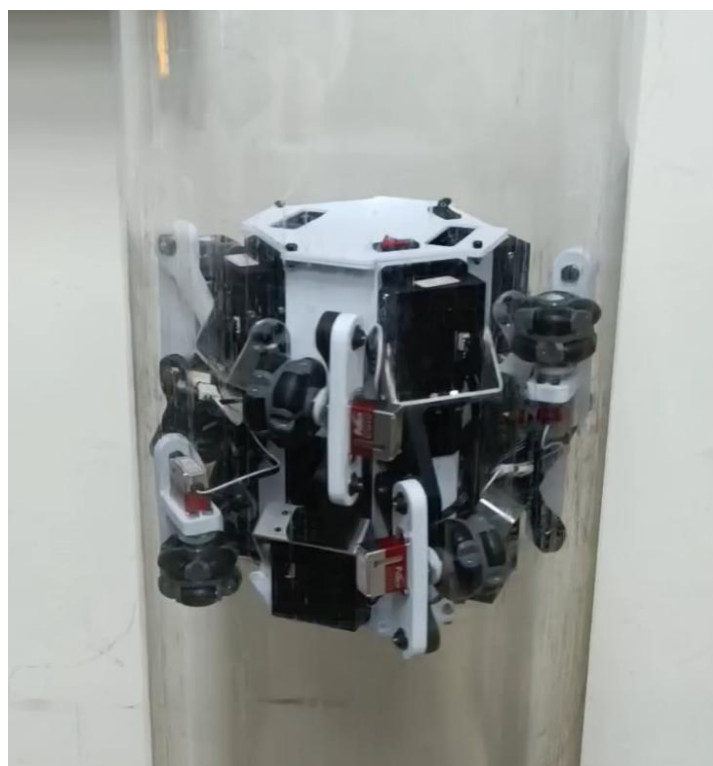
圖 5-3-2-35 多模式管道機器人進行爬升運動
