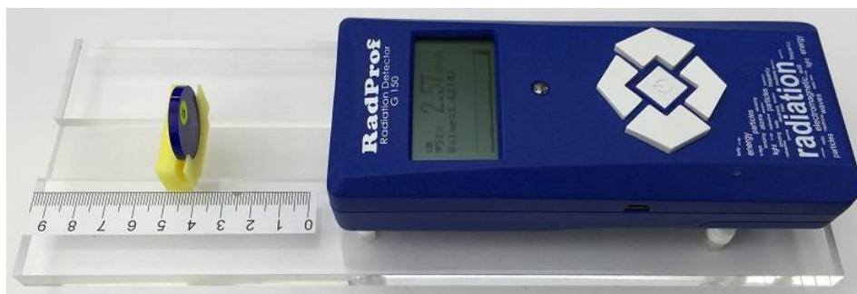
簡易型手持式游離輻射偵測器偵測放射源工作圖
