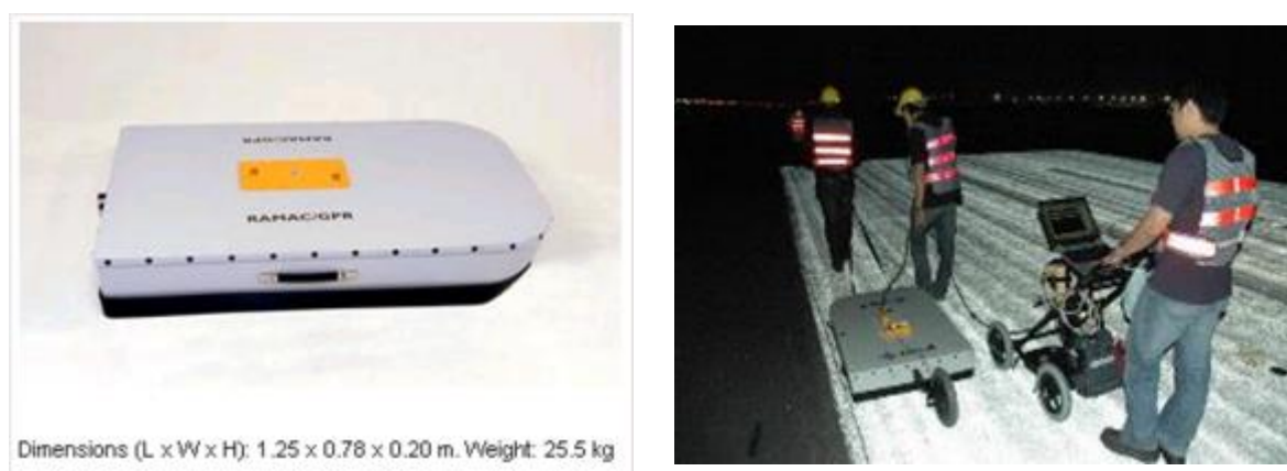
圖 4.11 100MHz GPR 天線及現場檢測配置
