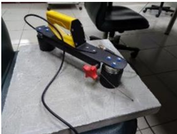
圖 3.14 採用波速量測雙探頭，版件經敲擊後所得訊號展示
