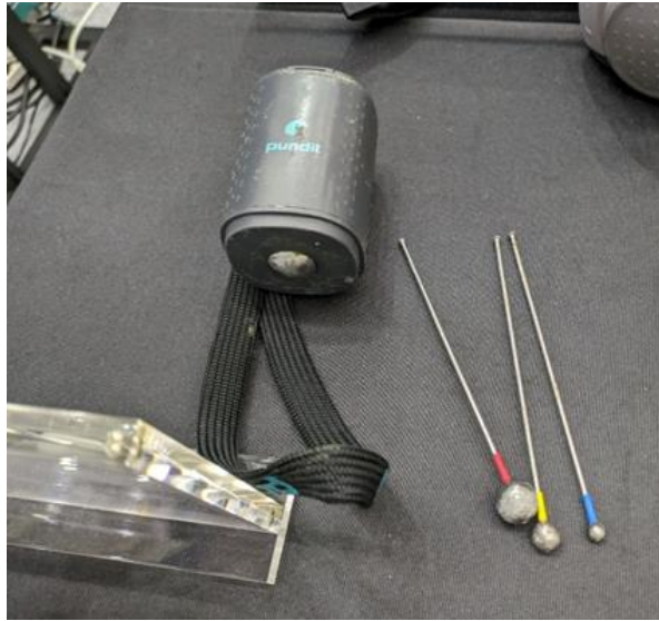
圖 5-10_ 敲擊回波檢測用速度規探頭，主要適用於程序 B。
