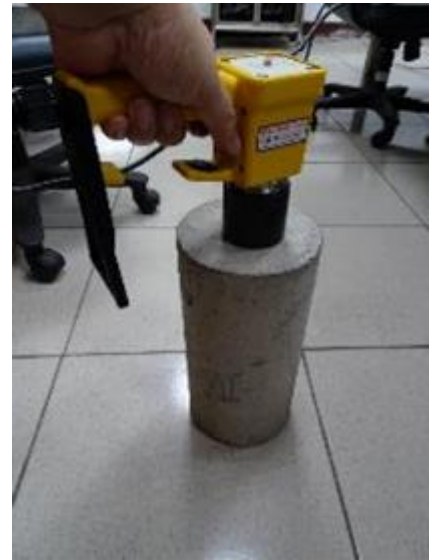
圖 3.12 採用 Pistol Grip Transducer 之圓柱試件敲擊配置及所得訊號
