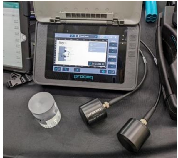
圖 5-10_ 敲擊回波檢測用速度規探頭，主要適用於程序 B。
