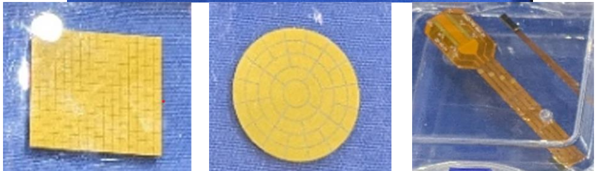
圖 3-1_陣列探頭用壓電晶片，壓電晶片上的切割槽用以分隔獨立起振及收訊單元。
