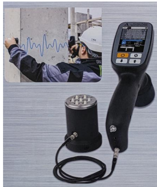
圖 5-10_ 敲擊回波檢測用速度規探頭，主要適用於程序 B。
