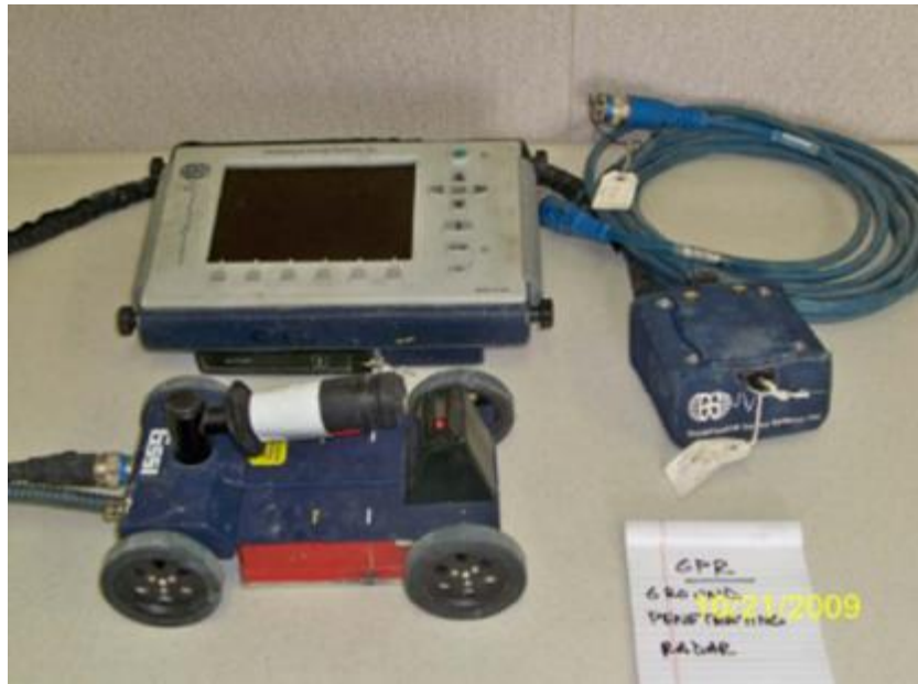
圖 4.21 水晶河 3 號核電廠採用的透地雷達檢測設備
