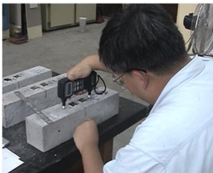
圖 5.2_採用 DPC 技術之波速量測儀 UK1401
