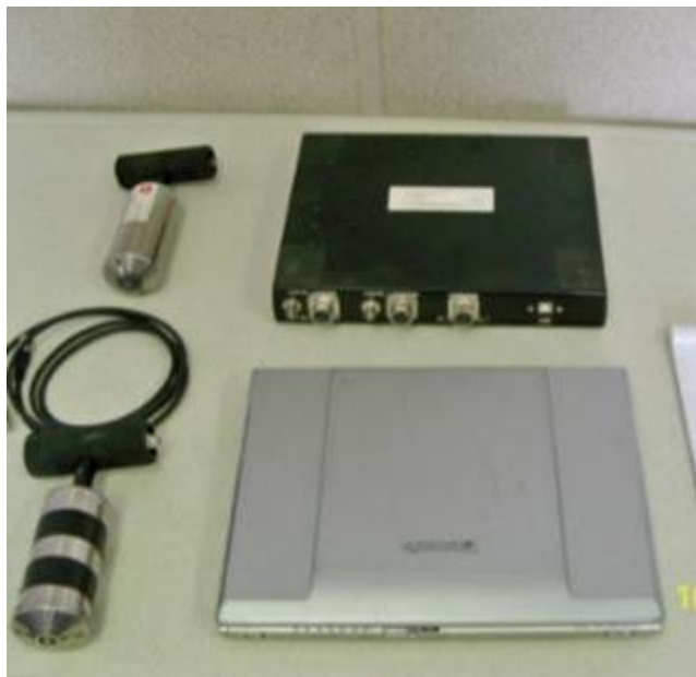
圖 3.1 水晶河 3 號核電廠採用之敲擊回音檢測設備
