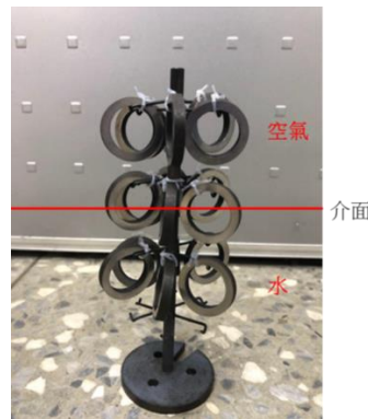
圖 2 實驗試片架設與實驗(3)之水的介面高度
