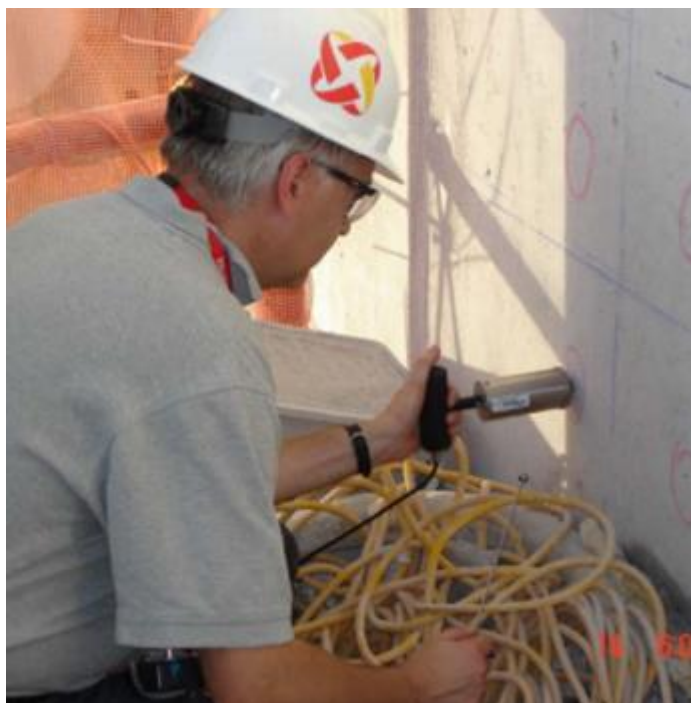
圖 3.2 水晶河 3 號核電廠之敲擊回音檢測
