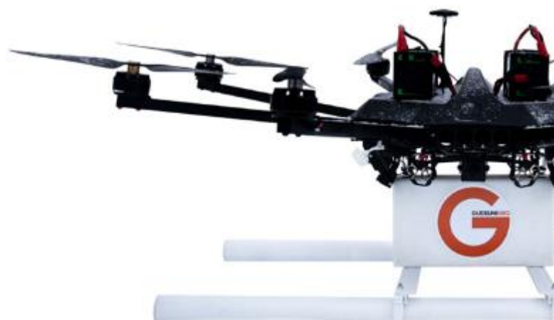
圖 4.20 GPR 天線及無人機載具配置(Mala 提供)
