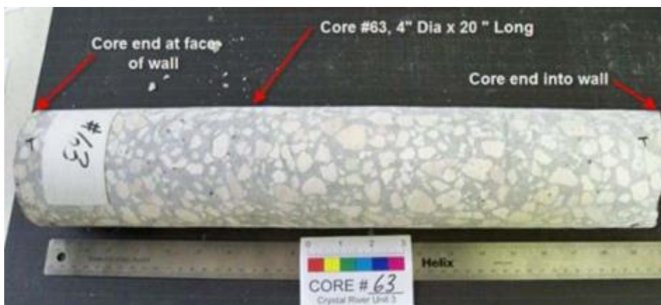
圖 2.11 圍阻體牆體上鑽心取樣
