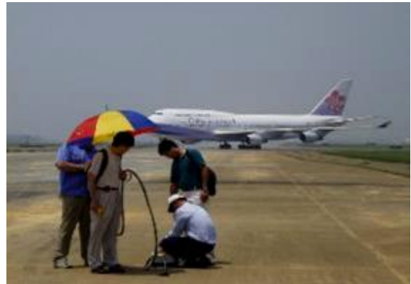
圖 4.14 800MHz GPR 天線及現場檢測配置
