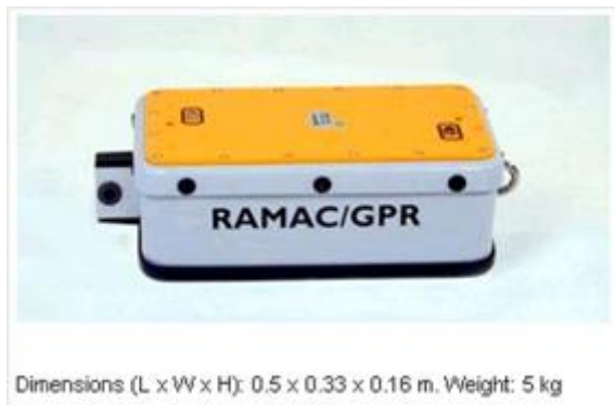
圖 4.14 800MHz GPR 天線及現場檢測配置
