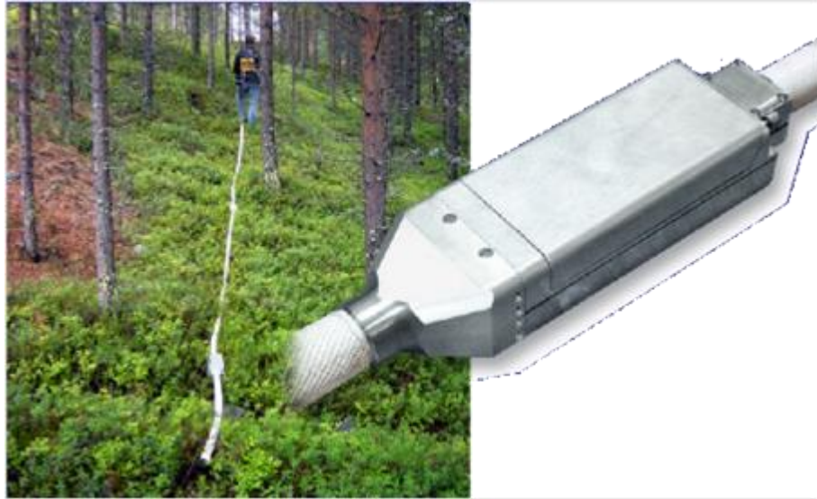
圖 4.10 50MHz GPR 拖曳天線及現場檢測(Mala 提供)
