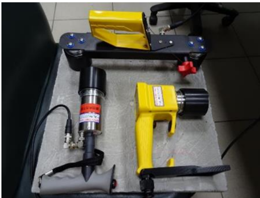
圖 3.10 位移規探頭共有三種型式：圓筒探頭(左下)、 槍把式探頭(右下)與波速量測雙探頭(上)
