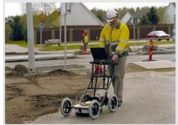
圖 4.13 500MHz GPR 天線及現場檢測配置
