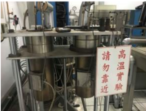
圖 20 壓力釜與恆溫控制系統
