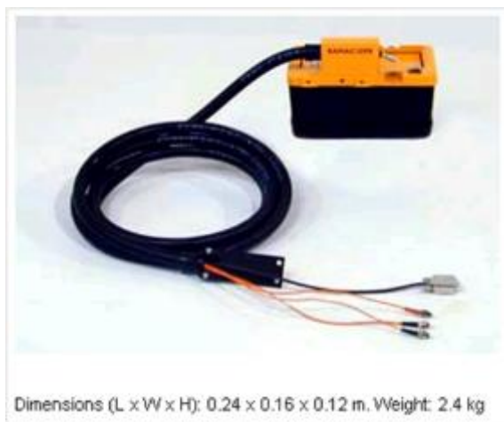
圖 4.15 1GHz GPR 天線及現場檢測配置
