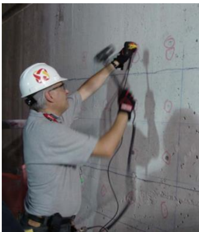
圖 3.4 水晶河 3 號核電廠採用之脈衝響應檢測
