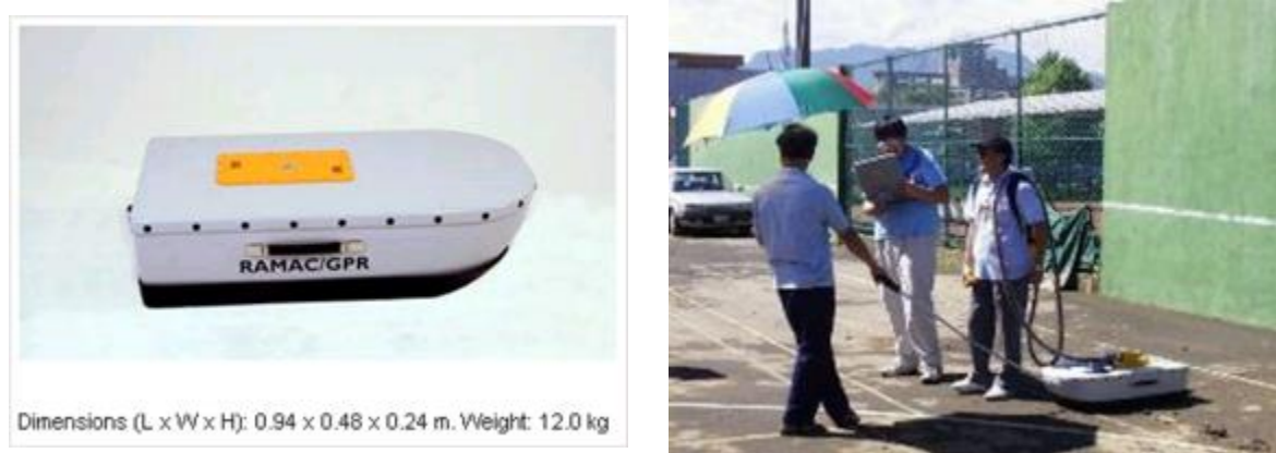
圖 4.12 250MHz GPR 天線及現場檢測配置
