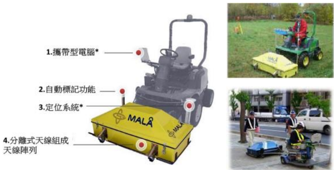
圖 4.18 3D 陣列式透地雷達系統及載具(Mala 提供)
