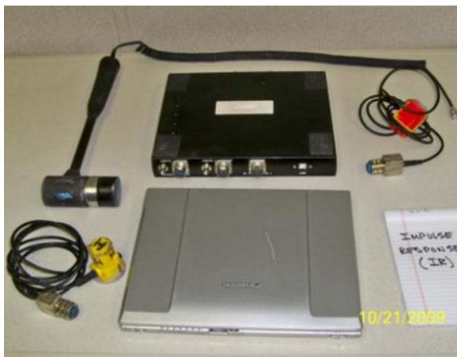
圖 3.3 水晶河 3 號核電廠採用之脈衝響應檢測設備
