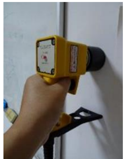
圖 3.13 採用 Pistol Grip Transducer 敲擊牆體後所得訊號展示
