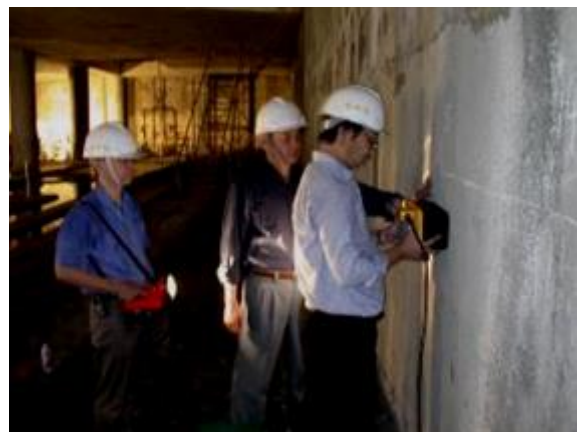
圖 4.15 1GHz GPR 天線及現場檢測配置
