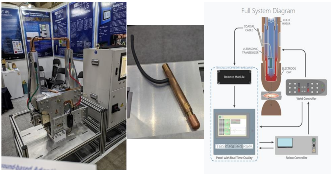
圖 3-4_分析系統及埋有超音波探頭之銲頭
