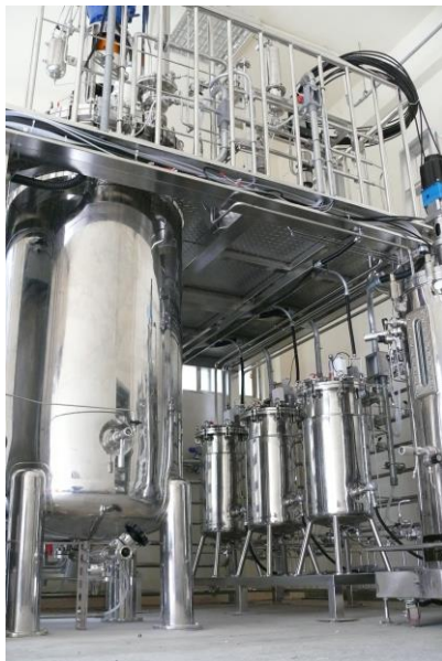
圖 15、本研究建置之 1000L 酵素生產發酵槽
