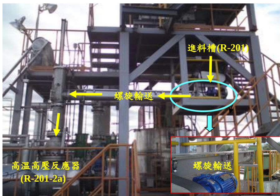
圖 3、噸級前處理系統之連續式一階段酸催化蒸汽爆裂程序
