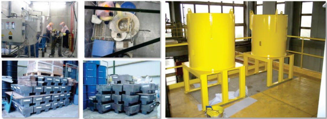
(a) 比利時SCK•CEN機構現場建置鉛熔煉設備製作鉛錠並無條件釋出
