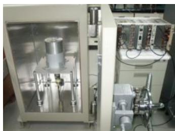
圖四、4 \pi NaI(Tl)井型偵檢器系統與效率校正曲線修正用鋁合金盛器套套件
