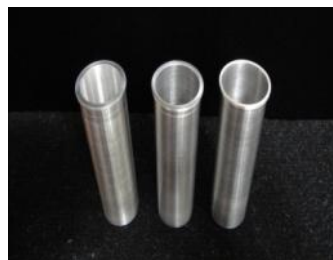
圖四、4 \pi NaI(Tl)井型偵檢器系統與效率校正曲線修正用鋁合金盛器套套件
