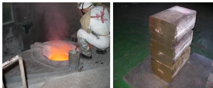
圖三、放射性污染廢銅熔鑄作業及熔鑄後銅錠
