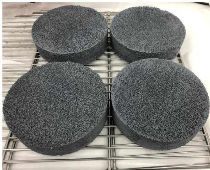
圖 1、多孔陶瓷試體除濕輪
