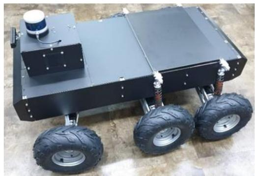
(c) 車台實體外觀圖，車輪可應多類型地形，並以輪速差進行轉彎
