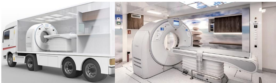
圖 45、車載型 CT 在肺癌篩檢車之示意圖 4
