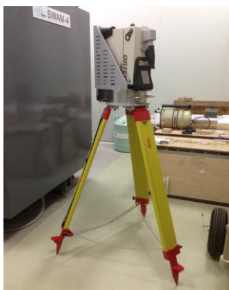
大型混凝土塊表面污染量測系統之架設情形
