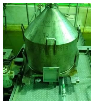
池水淨化設備拆解工具及輻射屏蔽除水裝置
