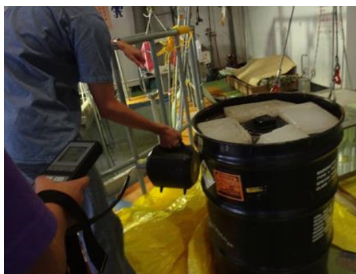
中子射源拆解包裝作業輻射量測
