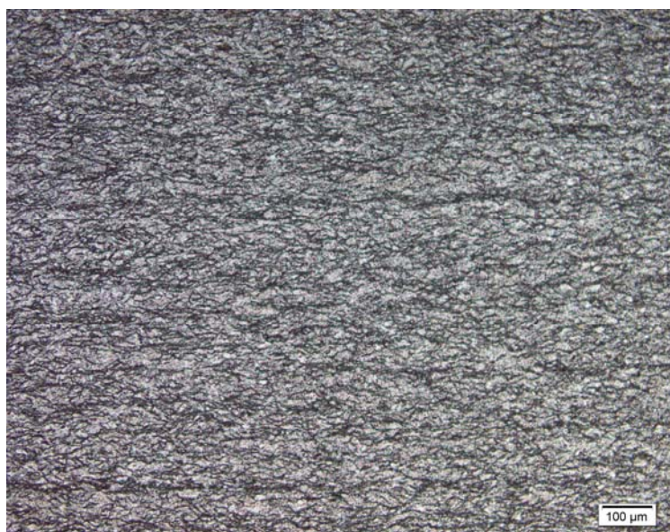
光學顯微鏡底下之充氫鋳四的照片。圖中黑色線條代表氫化鋳之析出，平均氫含
