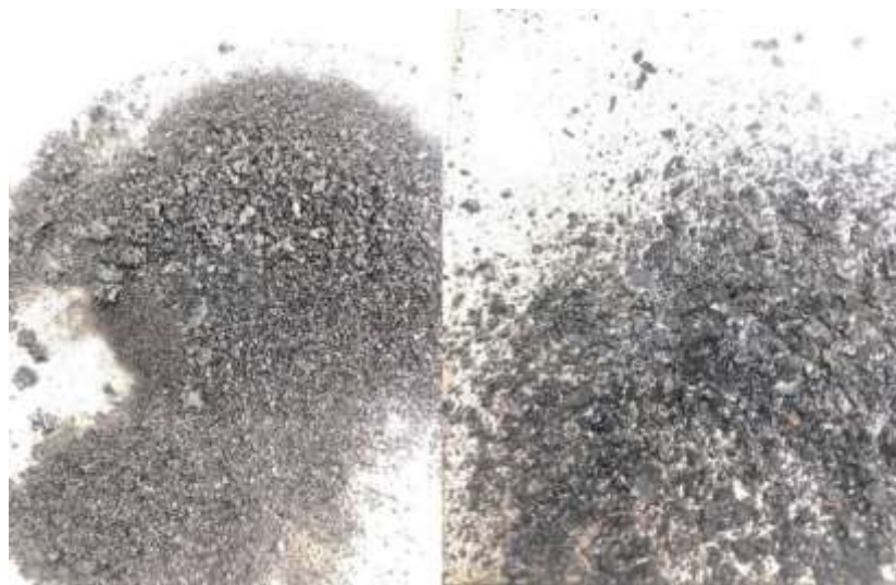
熔體淬冷後碎片圖(左圖為自然墜落淬冷碎片；右圖為沿爐壁滑落淬冷碎片)
