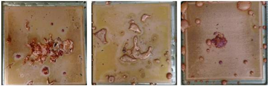
高溫熔融銅液於不同次冷度海水之淬冷後情況(由左至右次冷度分別為 72°C、50°C、20°C)
