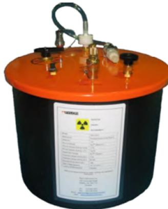
圖 9. 固體鐳-226 射源產生氦-222 參考物質(PYLON RN-105A)
