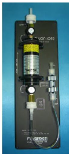
圖 10. 固體鈾-22 射源產生氦-220 參考物質((PYLON TH-1025)
