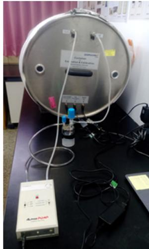
圖 6. 氡量測儀器校正系統圖
