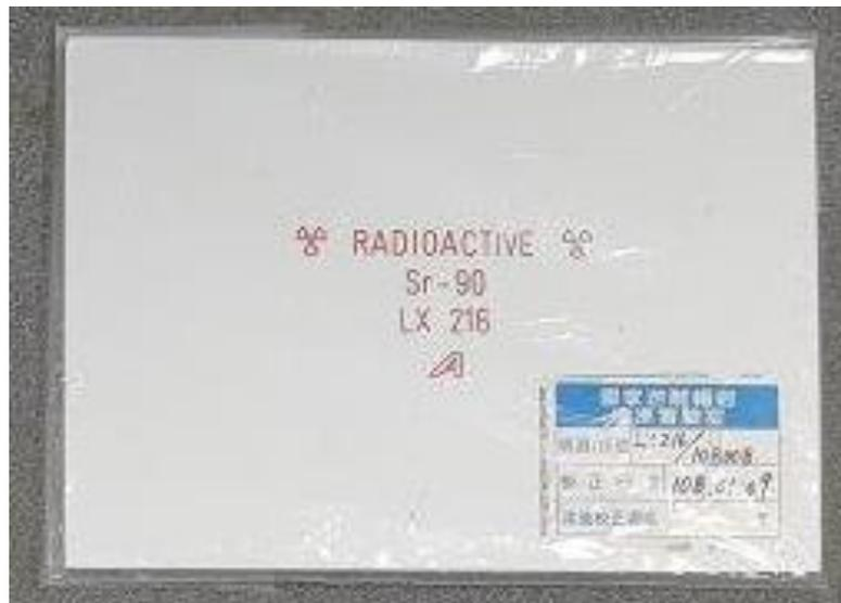
圖 3-10、Sr-90 密封校正射源(背面)
