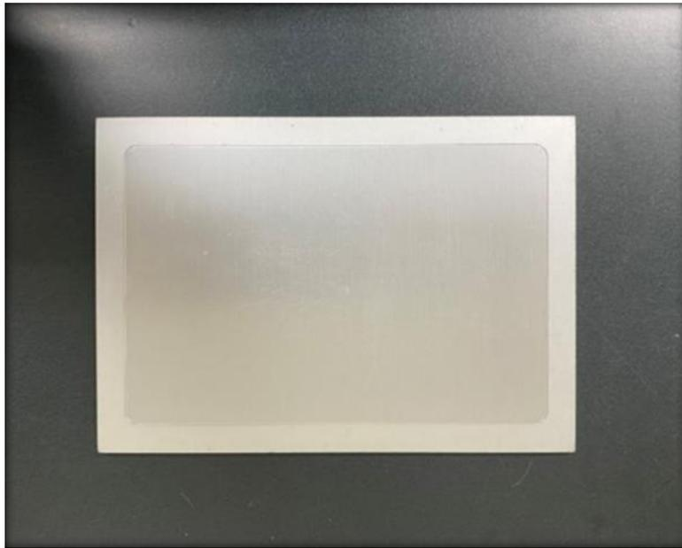
圖 3-11、Cs-137 密封校正射源(正面)
