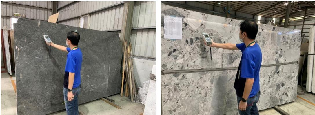
圖 25、石材劑量率量測
