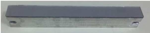
圖 32 光彈貼片黏貼於待測物上
