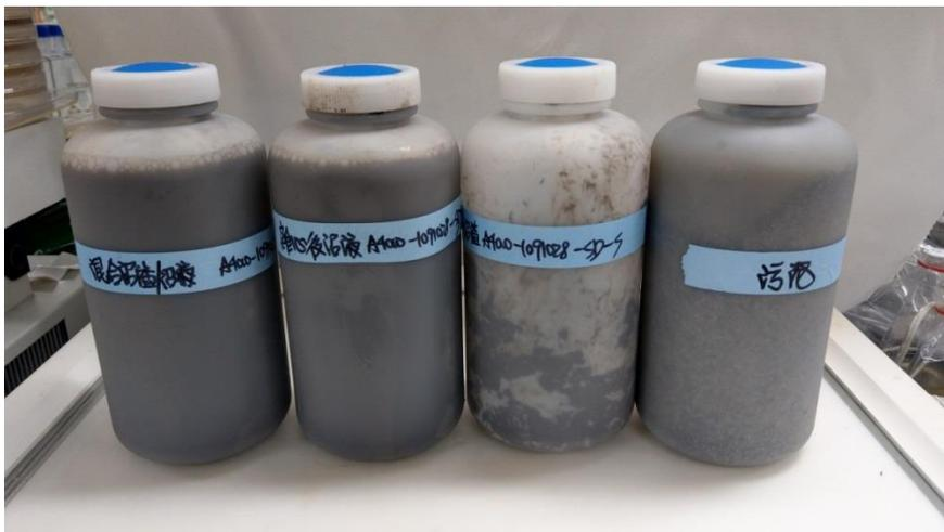
圖一、核研所沼液沼渣樣品。上圖為第一批次樣本，由左至右分別為混合沼液沼渣、離心沼液及離心沼渣。下圖為第二批次，由左至右分別為混合沼液沼渣、離心沼液、離心沼渣及汙泥。
