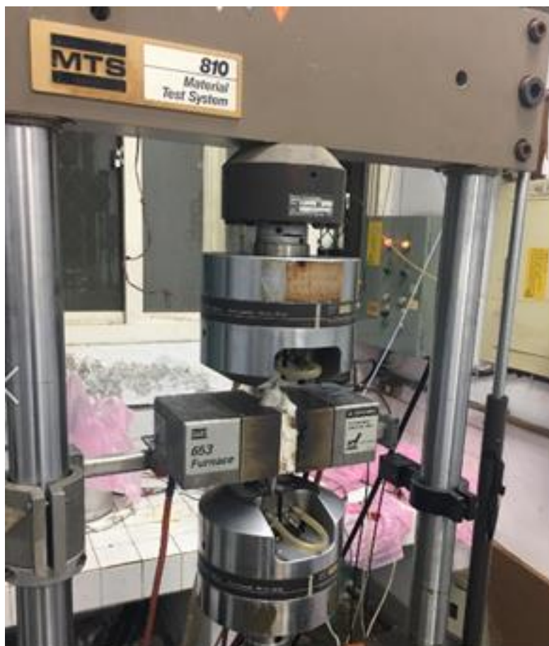
圖七、熱機疲勞試驗裝置
