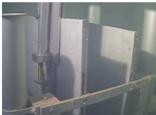
爐心內部水中取樣作業
