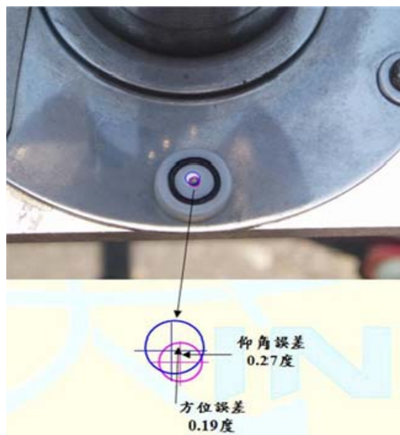
圖 44：完成改良型光感測器與改良型控制器，追蹤控制精度 \leq 0.3 度
