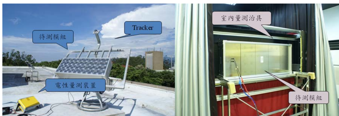
圖 33：閃爍式太陽電池模組特性量測系統
