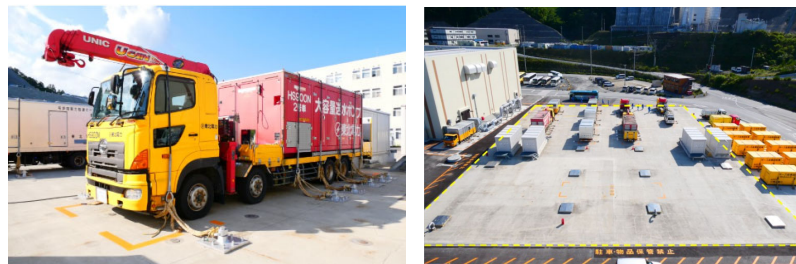
圖 4-50 移動式熱交換器機組/高壓代替注水設備 (Tohoku Electric Power Co., 2019)
