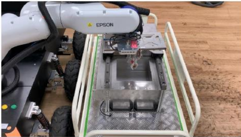
(a)遠端遙控行動式輻射偵測平台已完成階段性硬體開發建置，可搭配遠端遙控履帶式鉛罐車進行輻射事件之射源夾取、屏蔽與運送工作。
