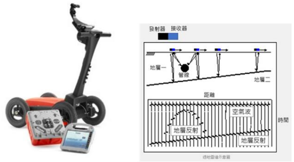
圖 II-6 透地雷達儀器檢測原理示意圖
