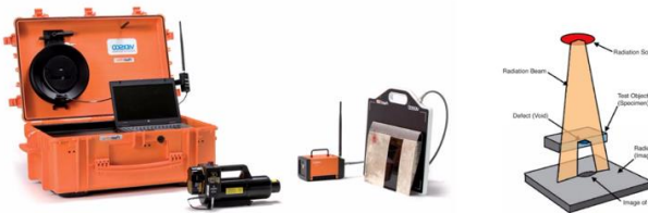
圖 II-3 射線檢測儀器及示意圖
