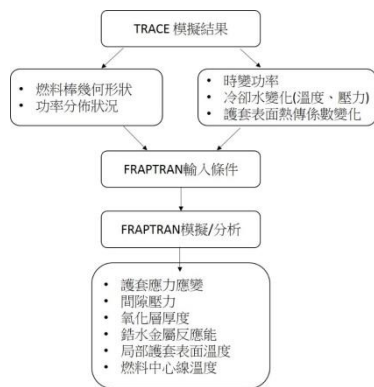
圖三：TRACE/FRAPCON/FRAPTRAN 結合模擬流程圖
