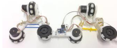
圖四、PIRATE 的管道機器人
