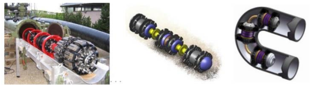
圖 II-8 智慧型清管平台實體及檢測示意圖
