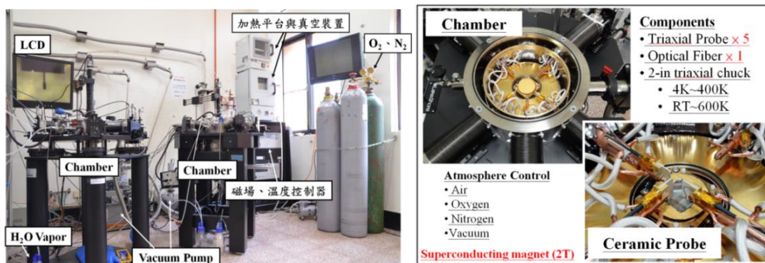
圖 2. (左)可控制量測環境之實驗平台(環境氣氛:大氣、真空、氧氣、水氣、氮氣。溫度:4K~400K) (右)實驗平台腔體內部。
