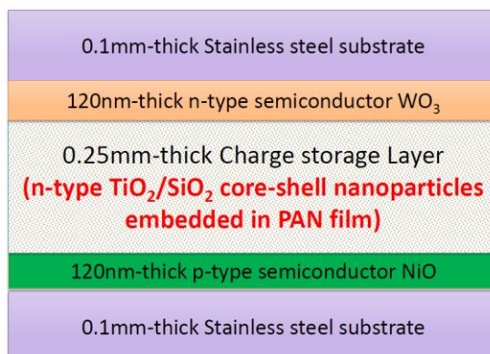
圖11. 開發的固態半導體電池元件結構示意圖
