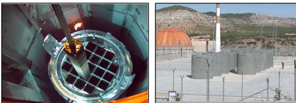
圖 2-7 用過核燃料移出過程與存放區域
