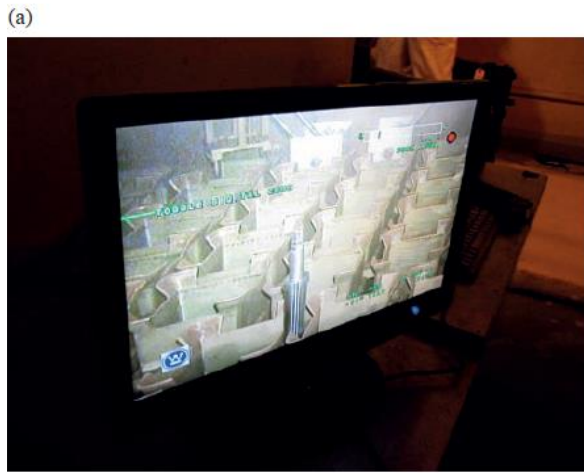
圖 1-22 用過燃料池的水下檢查
