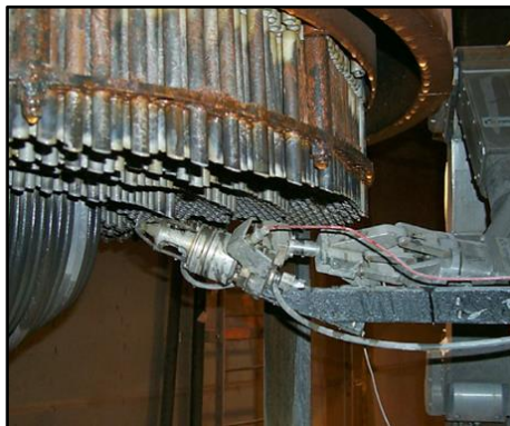
圖 2- 19 管束切割使用 HPWJ，並以 MAESTRO 機械臂作為工具載具
