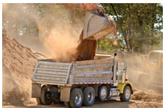
圖 3- 25 用於運輸 K-25 除役工程中所產生之受污染材料的大型自卸卡車車斗[16]
