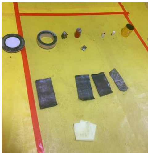
圖 3-27 受放射性污染的測試樣品，如鉛片、鉛磚、鉛罐（lead pigs）及鉛襯手套[16]
