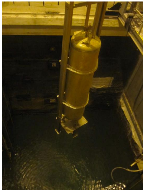
圖 1-27 可水下沈浸的過濾設備
