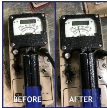
圖 3-26 雷射除污前後之污染物放射劑量[16]
