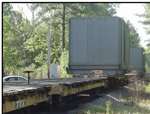
圖 2- 60 以鐵路運送蒸汽產生器下半部
