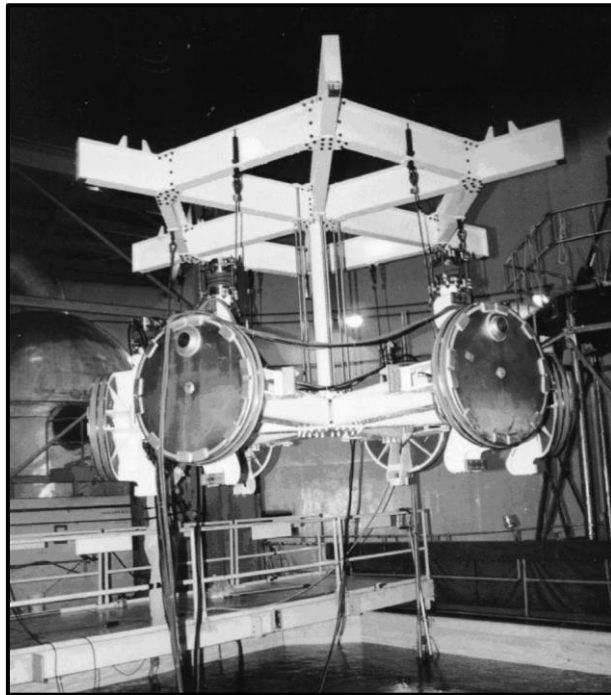
圖 2- 56 六爪式 Flow-Through Nozzle Dam Spider，在 CY 中改良為八爪式
