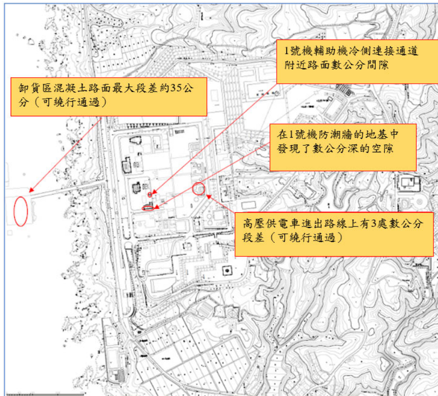
圖 3-98 志賀核電廠廠址內地面的調查狀況（北陸電力株式會社）
