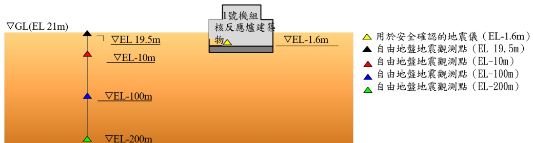
圖 3-124 安全確認用地震儀安裝位置及地面地震觀測點圖
