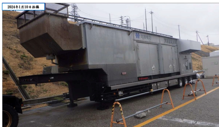
圖 3-64 備用電源－大容量電源車（北陸電力株式會社）
