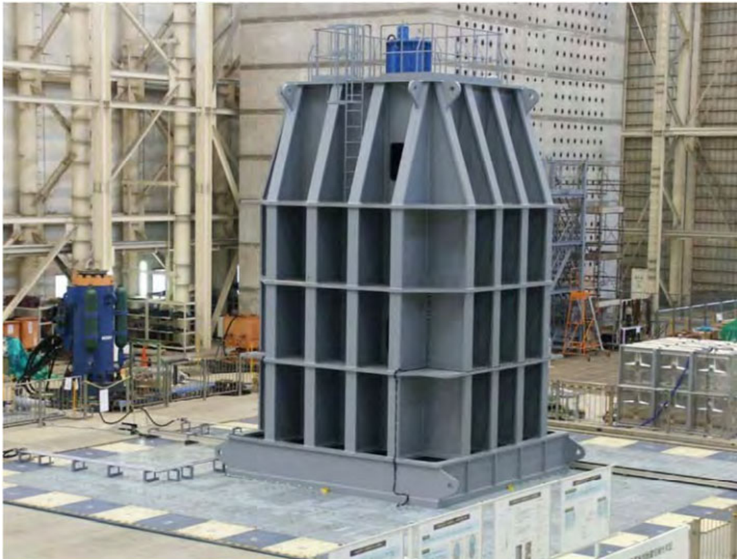
圖 2-25 BWR 控制棒插入系統試驗模型 (NUREG/CR-7040, p. 60)
