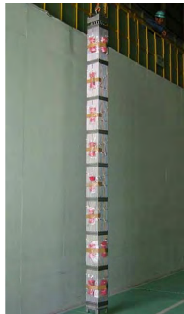
圖 2-24 PWR 燃料元件試驗模型 (NUREG/CR-7040, pp. 54-55)
