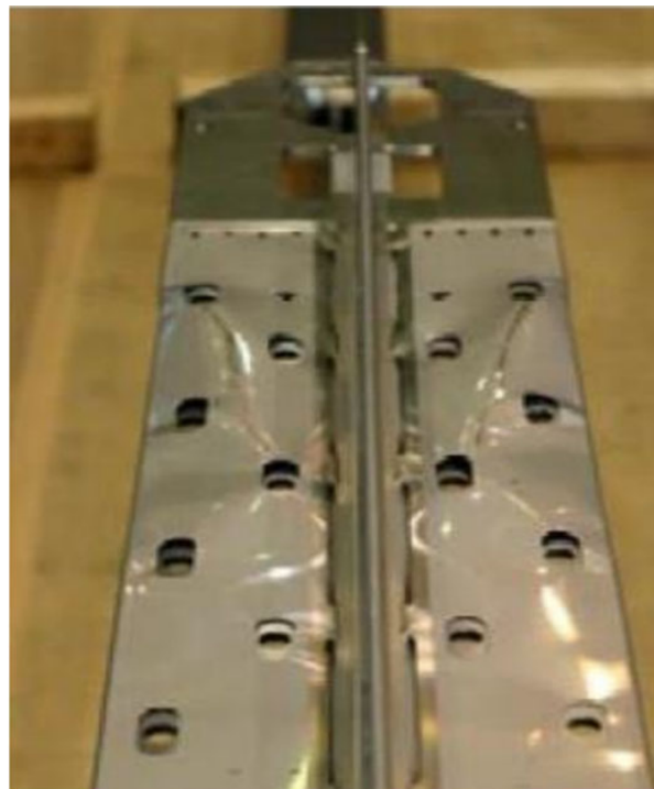
圖 2-30 BWR 控制棒表面變形(3 倍 S_2 ) (SMiRT-26 Test 2, p. 3)
